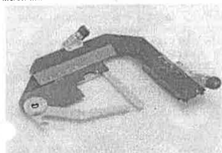
Фиг. 53: Поляризационна механична предметна масичка с възможност за закрепване
